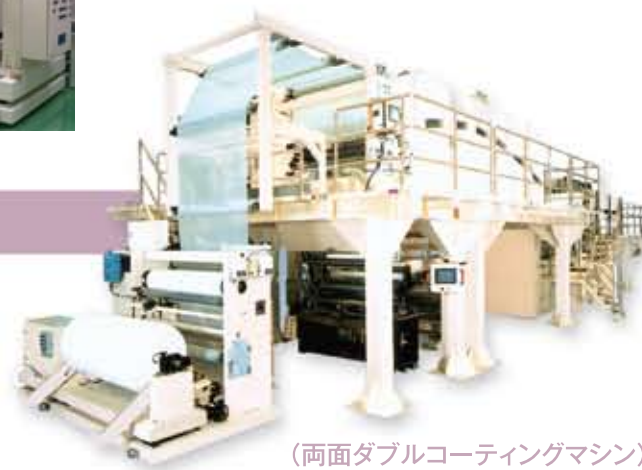
1600巾生産機コーティングマシン (マイクログラビア、ダイ塗工装置付)
