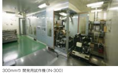
キュア炉付コーティングマシン (コーティング〜キュア ロールtoロール連続方式)
