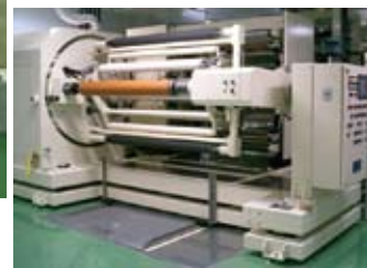
1600巾生産機コーティングマシン (マイクログラビア、ダイ塗工装置付)
